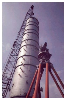
شکل ۵-۶ برج‌های استخراج مایع - مایع ستونی ایستا با سینی‌های غربالی
