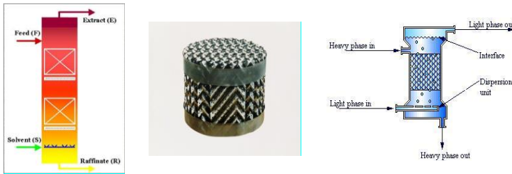
شکل ۷-۵- برج‌های استخراج مایع - مایع ستونی ایستا با پرکن
