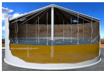
مخازن سقف شناور درونی
