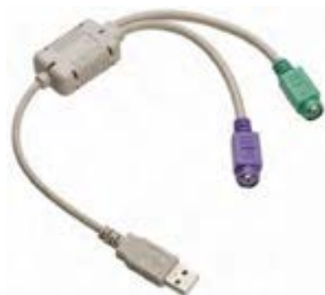
شکل ۴-۱- مبدل PS/۲ به USB
