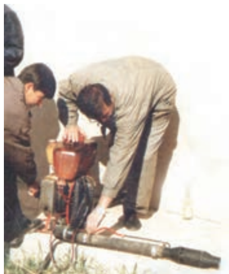
شکل ۲۵-۳- آماده سازی و روشن کردن شعله افکن
