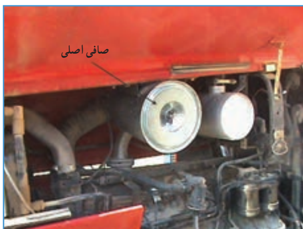
شکل ۵-۶ - محل قرار گرفتن صافی خشک در تراکتور MF399
