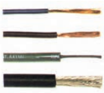
شکل ۵۵-۶- انواع سیم‌های مورد استفاده در مدارهای تراکتور
