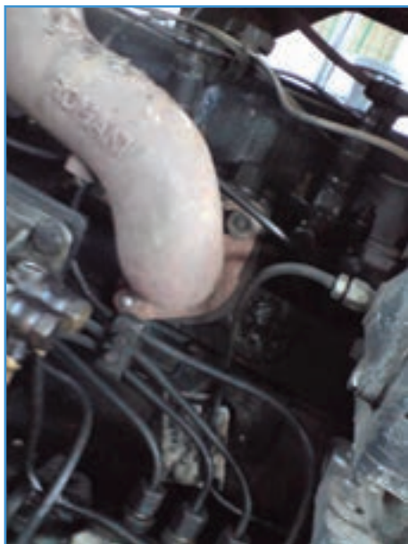
شکل ۳۱-۵- محل اتصال مانیفلد به سرسیلندر تراکتور U650
