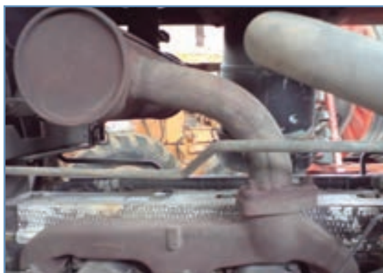
شکل ۳۰-۵- محل اتصال منبع اگزوز به مانیفولد
