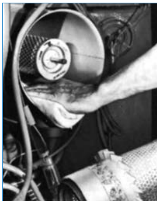
شکل ۱۳-۵ تمیز کردن بدنه صافی با پارچه
