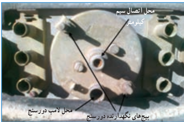
شکل ۸۲-۶- دورسنج از قسمت پشت داشبورد تراکتور U650M
