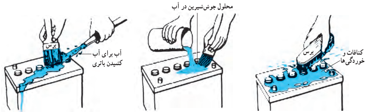
الف) تمیز کردن با برس و آب
