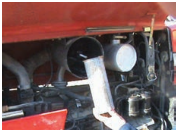
(الف) خارج کردن صافی ثانویه
