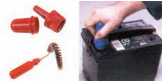
شکل ۲۳-۶- تمیز کردن قطب‌های باتری با ابزار مخصوص
