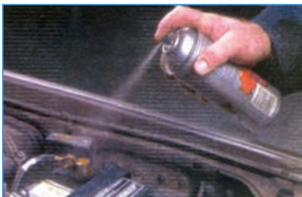
شکل ۱۱-۶- پاشیدن اسپری ضد خوردگی روی بست باتری
