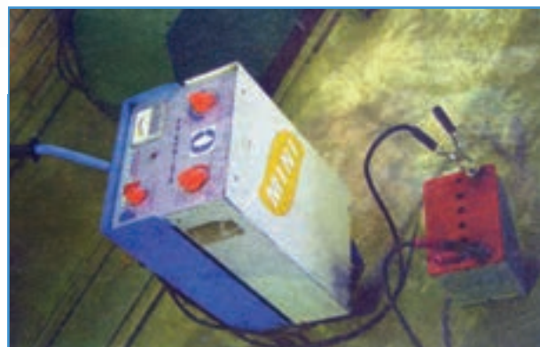
شکل ۱۸-۶ اتصال کابل‌های شارژر به باتری
