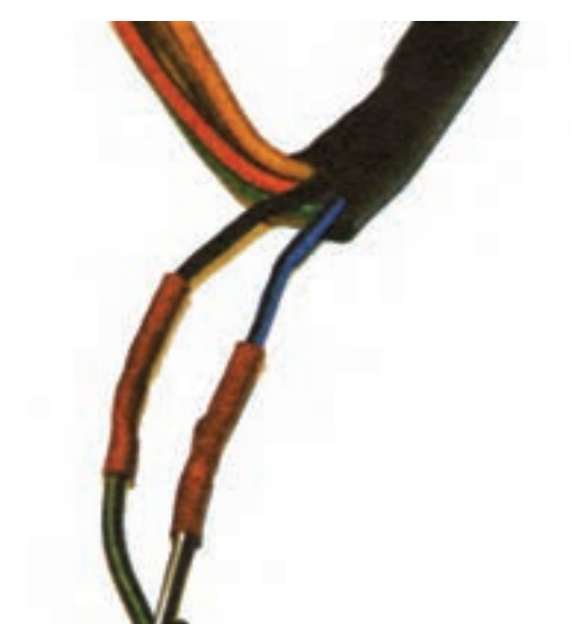
شکل ۶۵-۶- قرار دادن تیوب عایق روی محل اتصال سیم‌ها
