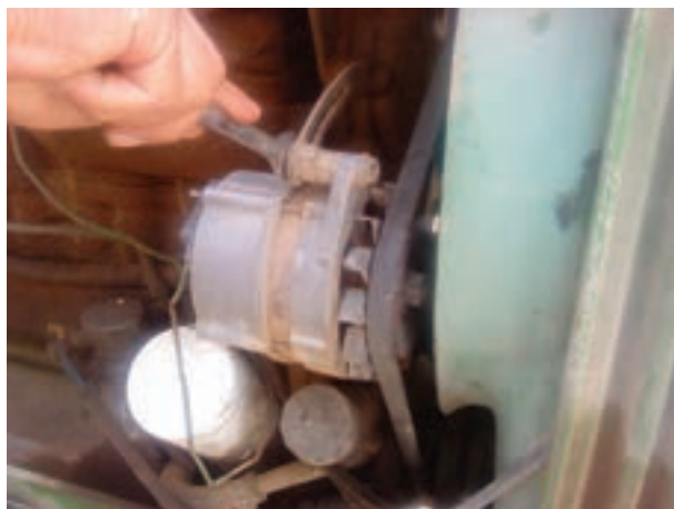
شکل ۳۸-۶ سفت کردن پیچ تنظیم آلترناتور
