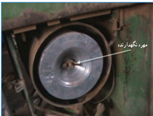
شکل ۱۰-۵ باز کردن شبکه بغل
