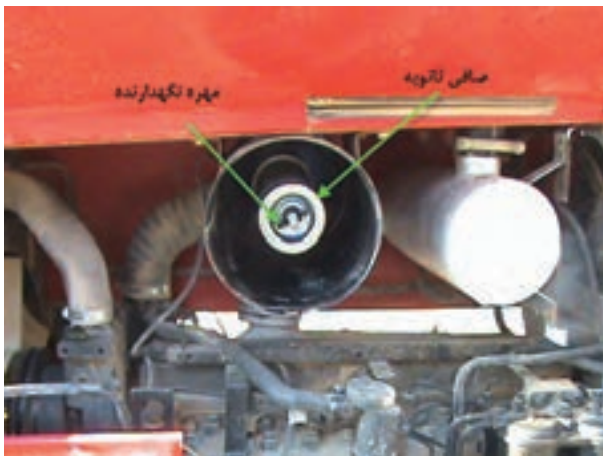
(ب) محل قرار گرفتن صافی ثانویه
