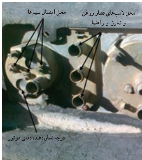
شکل ۸۵-۶- درجه نشان‌دهنده دمای آب از پشت داشبورد تراکتور U650
