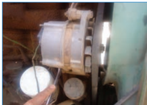
شکل ۳۱-۶ باز کردن پایه آلترناتور
