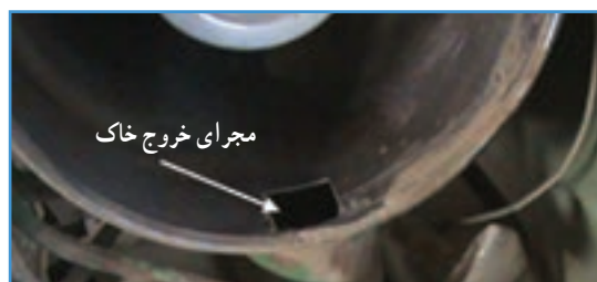
شکل ۱۱-۵ محل خاکدان در تراکتور جاندر
