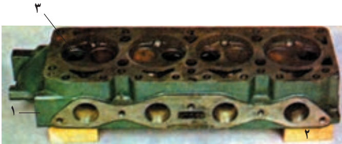
۱- سرسیلندر ۲- قطعه چوب ۳- نشیمنگاه
