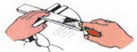
شکل ۳-۱۸ - کارهای کوچک و براده برداری مختصر
