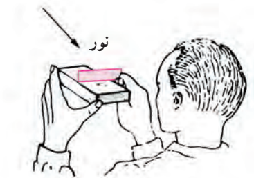
شکل ۱-۲۳- کنترل زاویه قائمه با گونیا
