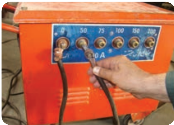
تنظیم آمپر در دستگاه ترانسفورماتور پله‌ای
