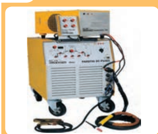
دستگاه فرآیند جوشکاری قوسی با الکتروود تنگستن تحت پوششی گاز خنثی
