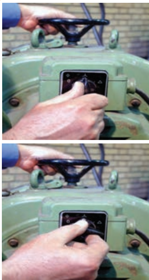
دینام جوش کارگاهی و کلیدهای مخصوص روشن و خاموش کردن دستگاه
