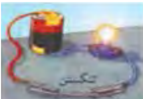
الف - سیم مسی در بین دو گیره سوسماری ب - سیم تنگستن در بین دو گیره سوسماری
