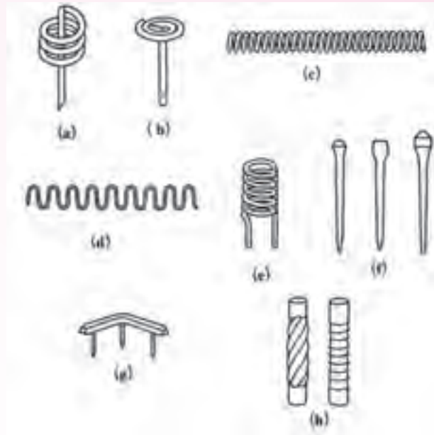
شکل ۳۹-۴- مثال‌هایی از مبردهای داخلی (a) مبرّد میخی مارپیچ (b) مبرّد میخی سرنخت (c) مبرّد فنری (d) مبرّد شبکه ای (e) مبرّد توپی (f) مبردهای میخی (g) مبرّد چندشاخه‌ای (h) مبرّد میله‌ای
