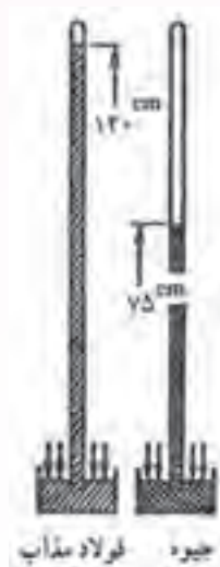
شکل ۴-۳۴- تأثیر فشار اتمسفر روی جیوه و فولاد مذاب
