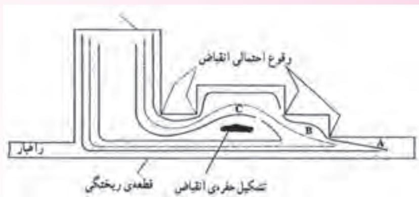
شکل ۴-۷- اثر مراکز گرمایی منطقه‌ای در انقباض آلیاژهای پوسته‌ای
