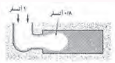
شکل ۳۰-۴- چگونگی عمل مذاب‌رسانی یک تغذیه باز با استفاده از فشار اتمسفر
