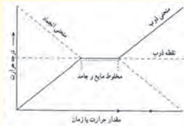
شکل ۱-۴- منحنی ذوب و انجماد فلز خالص
