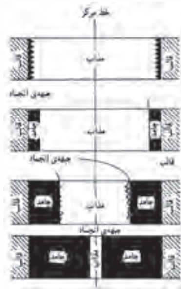
شکل ۴-۴- شماتیک مراحل انجماد یک فلز خالص (با دامنه انجماد صفر) انجماد از جداره قالب آغاز شده و به طرف مرکز ادامه یافته و جبهه انجماد به شکل صاف و همواره است
