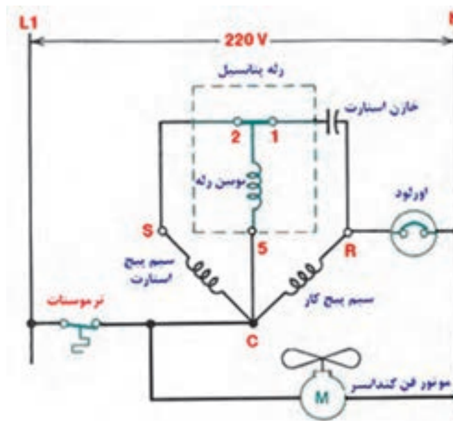
شکل ۱۸-۱۰- مدار الکتریکی آب سردکن
