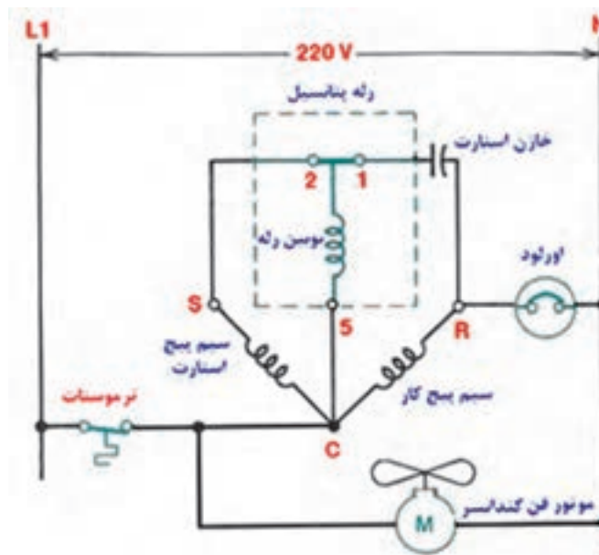
شکل ۱۸-۱۰- مدار الکتریکی آب سردکن
