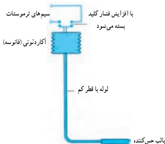
شکل ۹-۱- اساس کارکرد ترموستات بالب و فانوسه‌ای پر شده با مایع یا گاز
