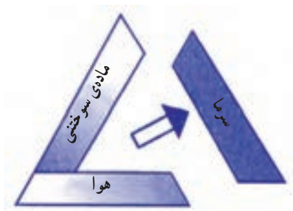
شکل ۱۵-۱- سرد کردن ماده‌ی سوختنی
