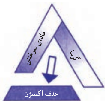
شکل ۱۶-۱- ممانعت از رسیدن اکسیژن به ماده‌ی سوختنی
