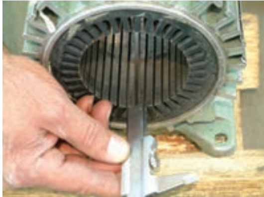
شکل ۲۶-۲- اندازه گیری محیط داخلی و طول شیار
