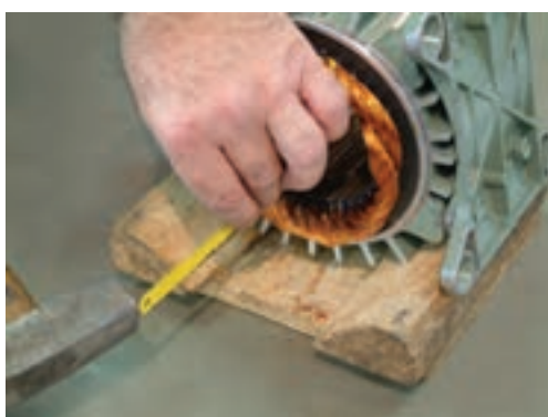
شکل ۲-۲۲ - بیرون آوردن گوه یا کاغذ برشمان از داخل شیارها
