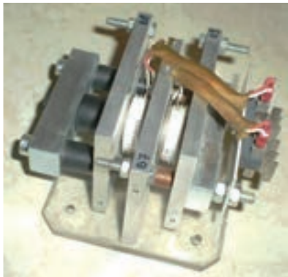
شکل ۳-۳- تریستورهای دیسکی همراه با گرماگیر
