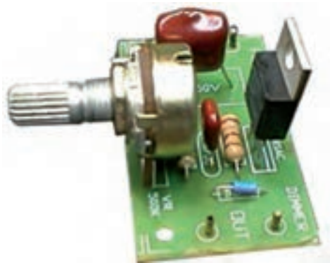
شکل ۳-۵۵- مدار ظاهری یک دایمر روشنایی
