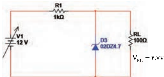
شکل ۱-۴۹- مدار رگولاتور ولتاژ با دیود زنر
