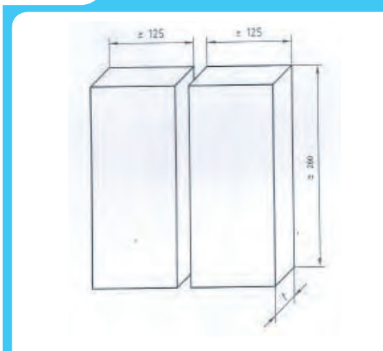
ابعاد نمونه آزمون برای جوش شیاری در ورق
