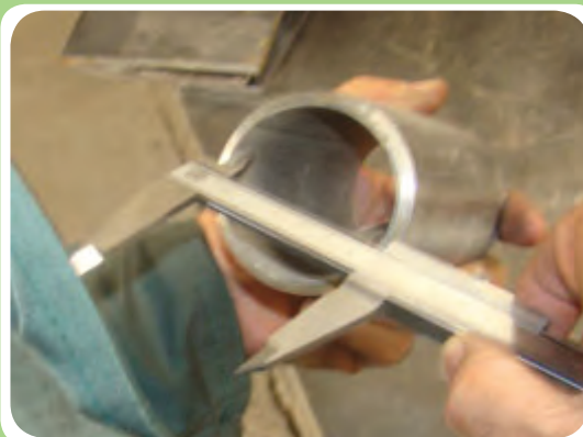
اندازه‌گیری قطر داخلی لوله توسط کولیس
