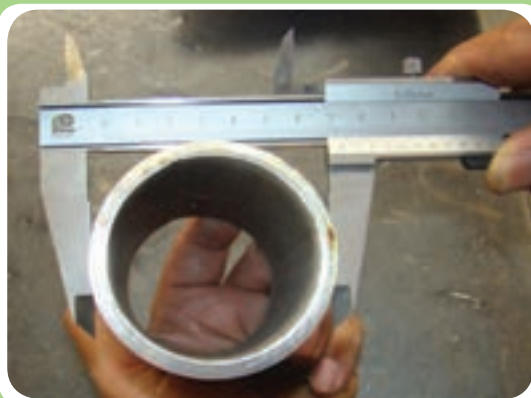
اندازه‌گیری قطر خارجی لوله توسط کولیس
