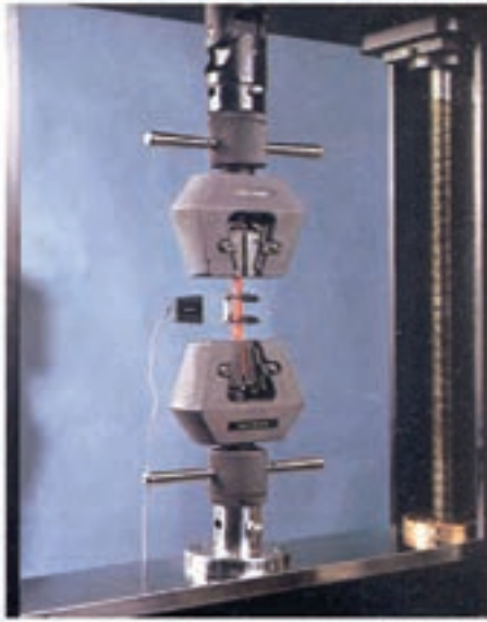
دستگاه آزمون کشش برای اندازه‌گیری استحکام مواد فلزی
