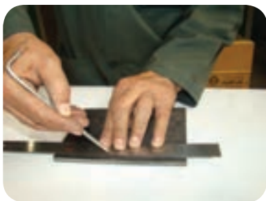
علامت گذاری با استفاده از خط کش و سوزن خط کش روی ورق فولادی
