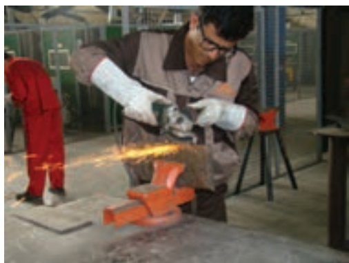
تشخیص نوع فولاد بر اساس آزمایش جرقه
