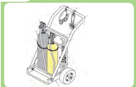
گاری مخصوص حمل کپسول‌های گاز در کارگاه
