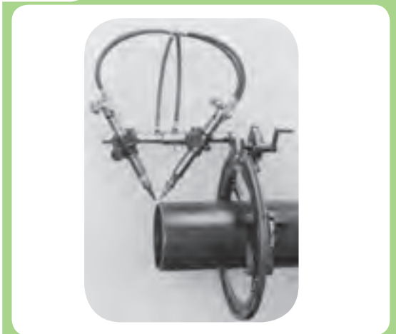
برشکاری و پخ‌سازی لوله فولادی به‌طور هم‌زمان
