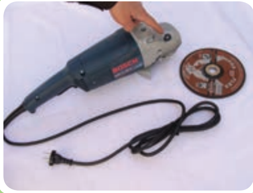
کلید مخصوص قفل کردن محور سنگ
