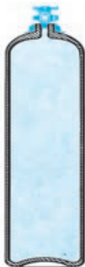
کپسول فولادی مخصوص برای ذخیره اکسیژن
