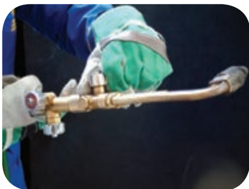
باز کردن شیر محصول استیلن قبل از روشن کردن مشعل
