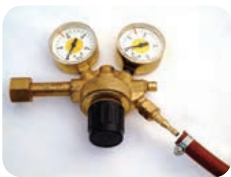
اتصال شیلنگ به رگولاتور گاز
