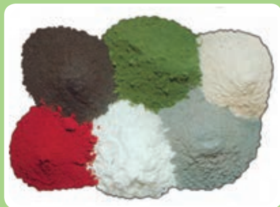
مواد پودری تشکیل دهنده روپوش الکترود
