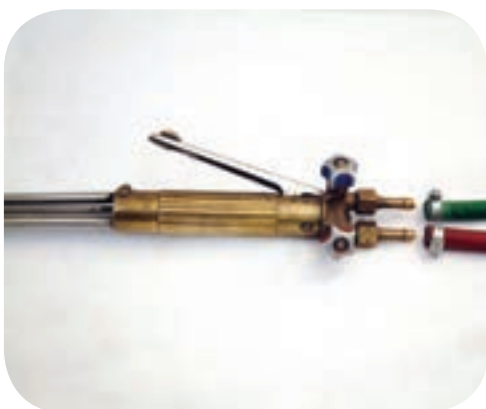
اتصال شیلنگ گاز اکسیژن و استیلن به مجاری اختصاصی خود در مشعل برشکاری
