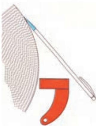
تیز کردن سوزن خط کش
