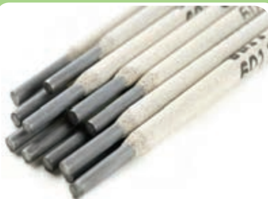
الکترودهای روپوش‌دار مورد استفاده در فرآیند جوشکاری قوس الکترودهای دستی
