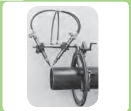
برشکاری و پخ‌سازی لوله فولادی به‌طور هم‌زمان
