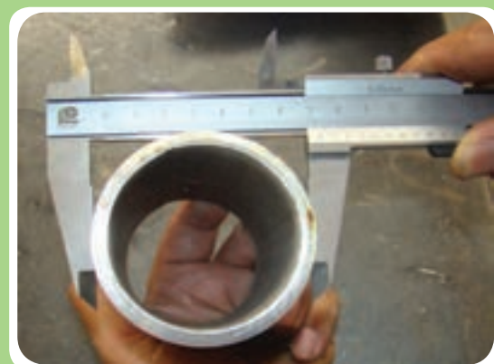
اندازه‌گیری قطر خارجی لوله توسط کولیس
