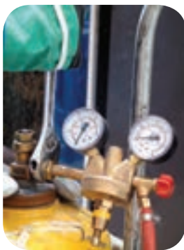
محکم کردن اتصالات رگولاتور به کپسول گاز
