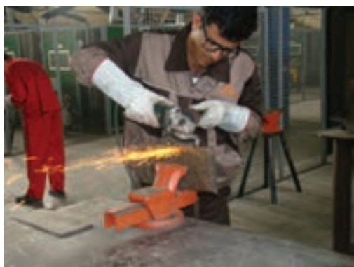
تشخیص نوع فولاد بر اساس آزمایش جرقه
