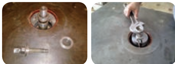
شکل ۲۸-۲- تنظیم کردن تویی در دستگاه فرز
