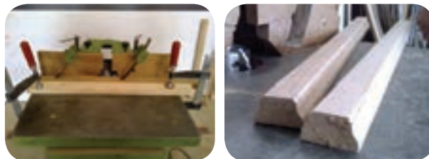
شکل ۲-۳۰- چوب ابزار خورده، ابزار زدن قطعه کار
