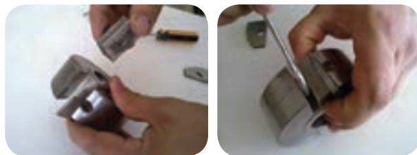
شکل ۲۷-۲- تنظیم و محکم کردن تیغه داخل تویی
