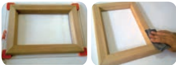
شکل ۲-۳۴- پرداخت قاب ساخته شده، بستن قاب توسط گیره قاب بندی
