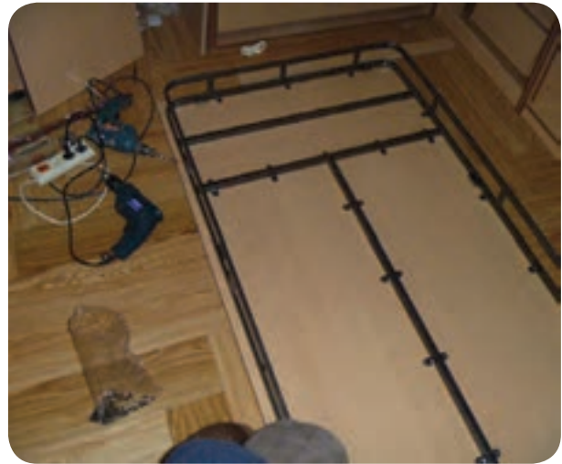
شکل ۱۳۰-۵- استقرار کلاف فلزی روی صفحه جلو تختخواب
