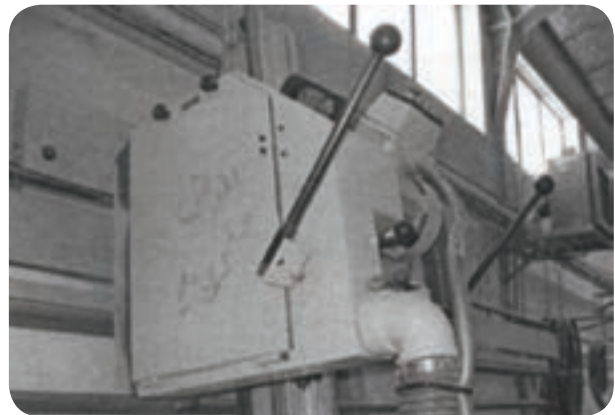
شکل ۳۹-۵- اهرم حرکت اره برای برش
