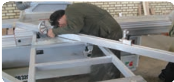
شکل ۵۰-۵- تنظیم دو کفشک کنترل اندازه گیری
