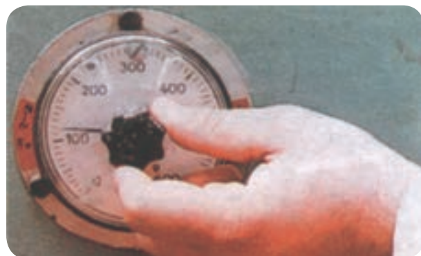
شکل ۷۹-۵- تنظیم فشارسنج پرس
