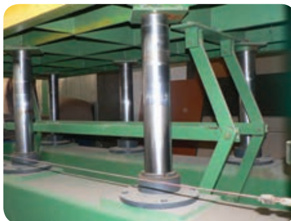
شکل ۸۹-۵- کنترل پیستون و سیلندرهای پرس
