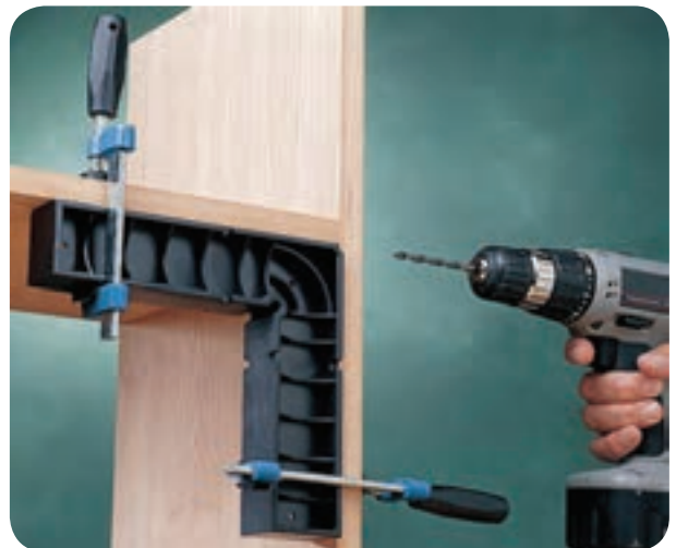
شکل ۱۷۰-۵- استفاده از شابلون برای جلوگیری از دوئیدگی
