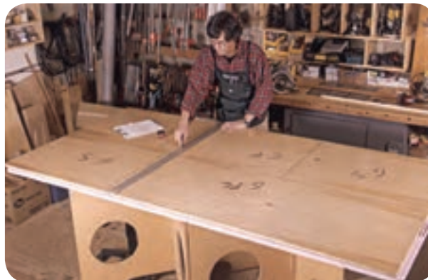
شکل ۴۷-۵- خط کشی صفحه ام دی اف برای برش
