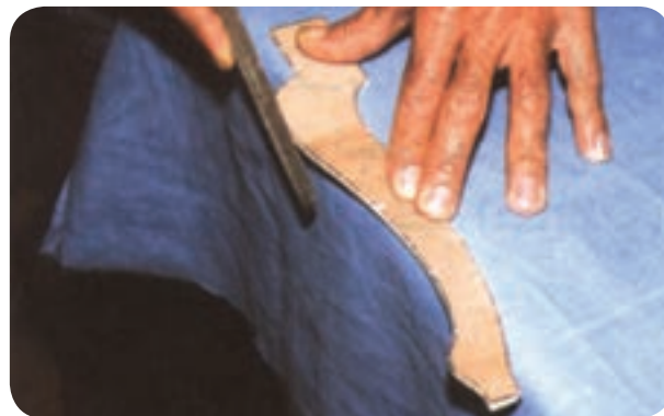
شکل ۵-۲۱- تهیه شابلن خط‌کشی برای ساخت پایه
