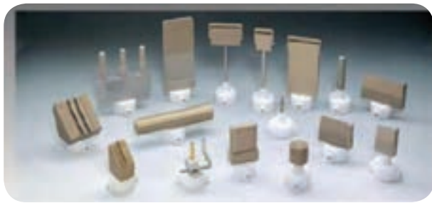
شکل ۹۴-۵- انتخاب ابزارهای جدید چسب‌زنی پنوماتیکی
