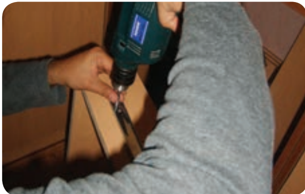
شکل ۱۷۶-۵- نصب ریل تکی به بدنه کشو
