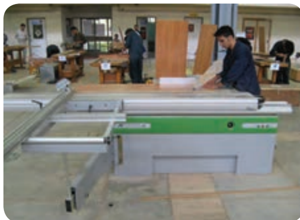
شکل ۱۱۵-۵- برشکاری قطعات سقف و کف
