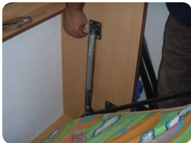
شکل ۵-۱۳۷ تنظیم فشار گاز سیلندر برای تعادل تختخواب
