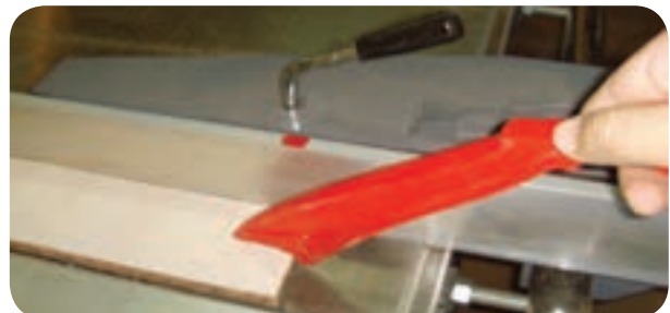
شکل ۱۰۵-۵- هدایت قطعه باریک به وسیله کمکی
