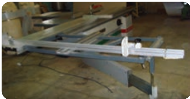
شکل ۴۹-۵- میله کشویی جلوی میز متحرک برای برش صفحات بزرگ
