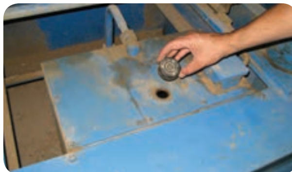
شکل ۸۸-۵- کنترل و تعویض روغن هیدرولیک مخزن
