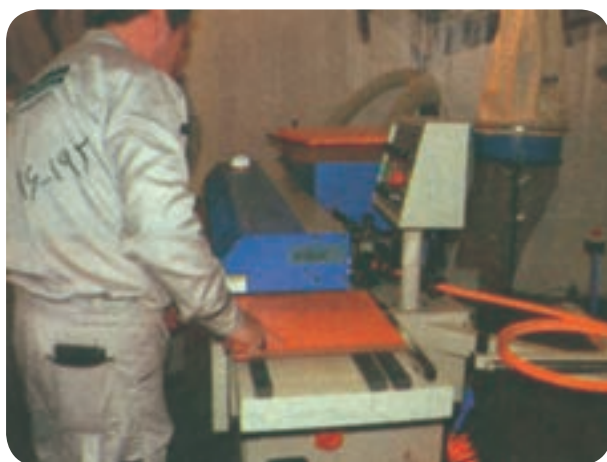
شکل ۱۱۸-۵- نوار چسبانی پی‌وی‌سی با ماشین لبه‌چسبان
