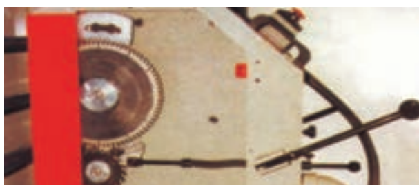
شکل ۳۵-۵- تیغه اصلی و خط زن اره پانل بر عمودی
