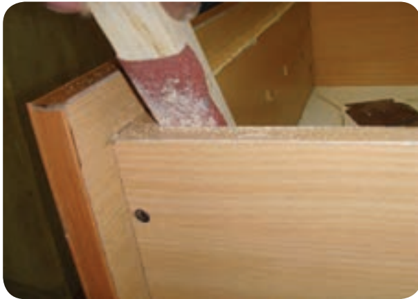
شکل ۵-۱۸۲- برطرف کردن لبه تیز صفحات با سوهان
