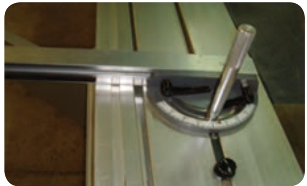
شکل ۵-۵۲- گونیای کوچک قابل تنظیم برای برشکاری
