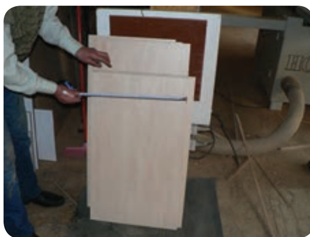
شکل ۱۱۶-۵- کنترل اندازه قطعات آماده شده
