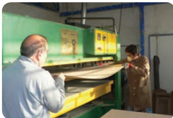
شکل ۵-۹۶- خارج کردن صفحات پرس شده
