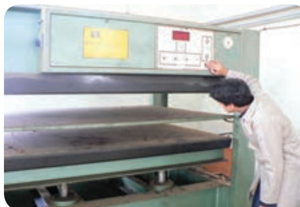
شکل ۸۵-۵: کنترل کار کردن صحیح پرس
