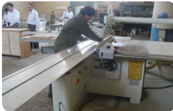
شکل ۴۸-۵- تنظیم گونای پشت اره دور کن
