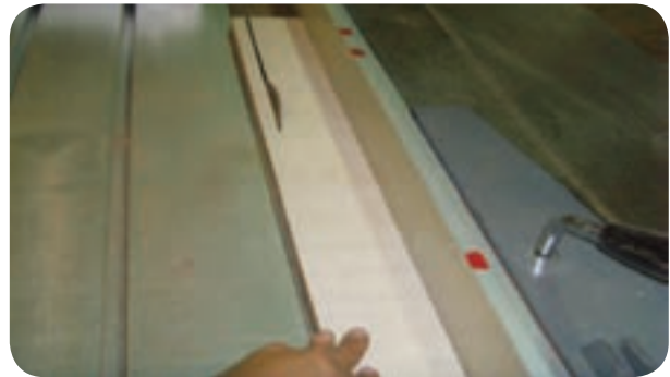
شکل ۱۰۴-۵- خطر پس‌زدن و پرتاب قطعه وجود دارد
