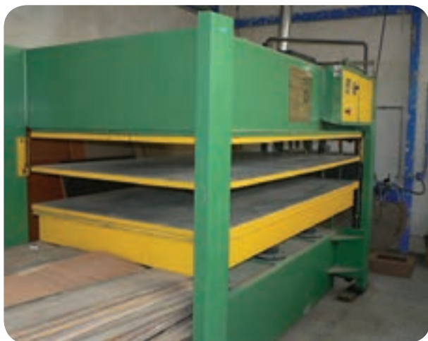
شکل ۷۵-۵ پرس سه طبقه روغنی هیدرولیک گرم
