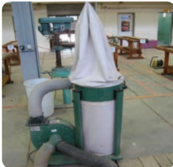
شکل ۲۴-۵- خروج ضایعات از طریق کانال پوشیده شده
