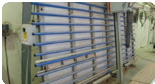
شکل ۳۷-۵- پانل بر عمودی ساده
