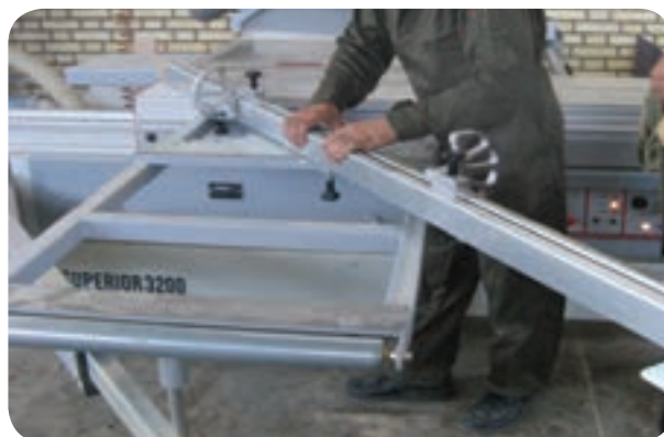
شکل ۵-۵۱- تنظیم گونیا با تکیه‌گاه برای برش کج صفحات
