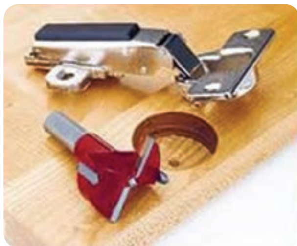
شکل ۱۴۹-۵ ایجاد جای لولای گازی در جوب به وسیله متنه مخصوص
