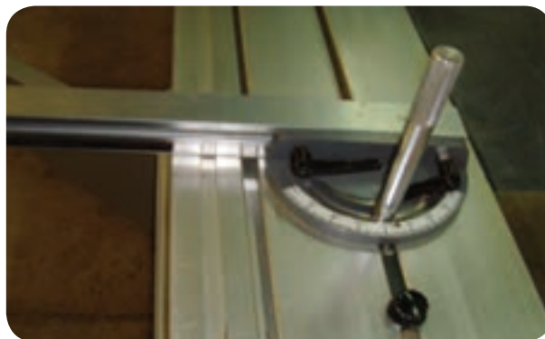
شکل ۵-۵۲- گونیای کوچک قابل تنظیم برای برشکاری
