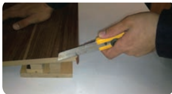
شکل ۴-۲۸ - قطع کردن سرو ته نوار با کاتر
