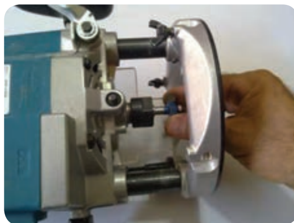
بستن تیغه در داخل دستگاه
