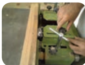
شکل ۲۹-۲- الف - بستن حفاظ ها
