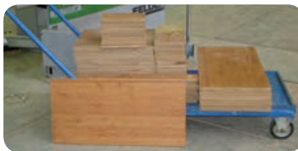
شکل ۴۱-۵ حمل صفحات بریده شده کوچک با گاری
