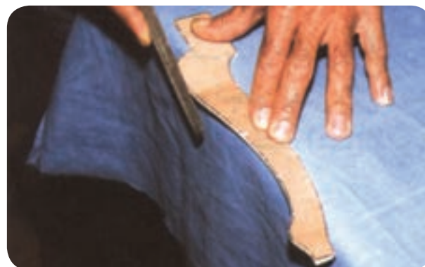
شکل ۵-۲۱ تهیه شابلن خط‌کشی برای ساخت پایه
