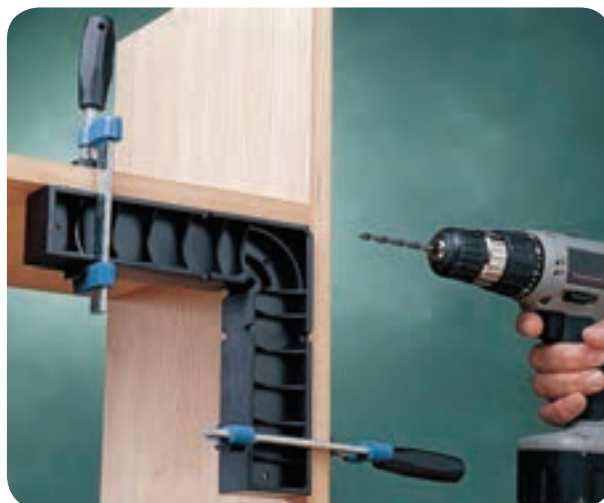
شکل ۱۷۰-۵- استفاده از شابلون برای جلوگیری از دوئیدگی
