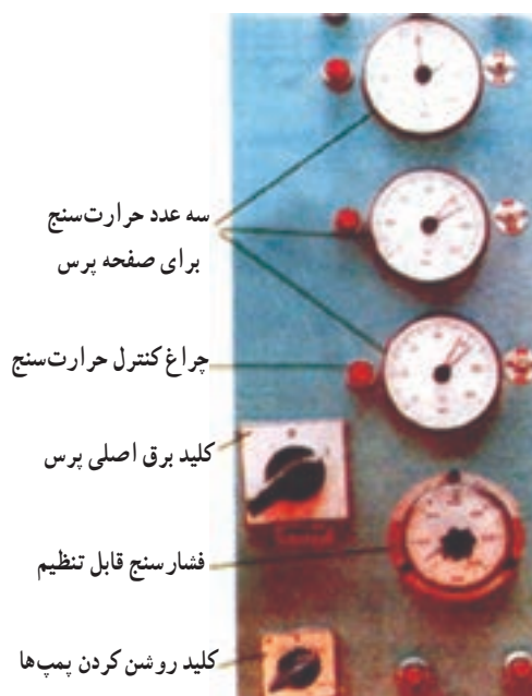
شکل ۵-۸۷- تنظیم اجزای پرس برای چسباندن روکش
