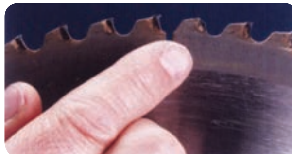
شکل ۴۲-۵ دندان‌های اره شکسته یا کند شده
