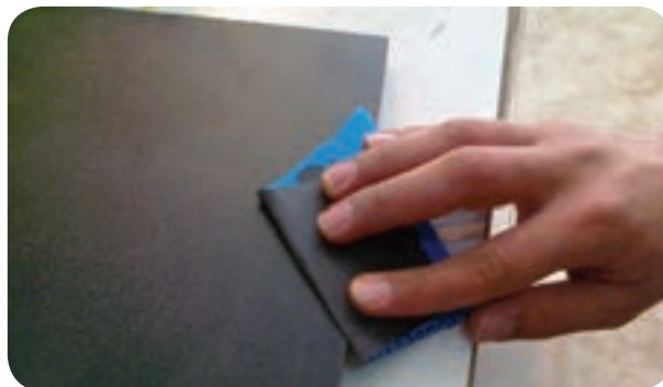
شکل ۴-۳۰ - پرداخت لبه لبه‌های نوار شده با سنباده
