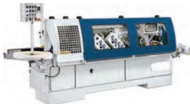
شکل ۴-۳۴- دستگاه پی وی سی صنعتی
