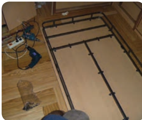
شکل ۱۳۰-۵- استقرار کلاف فلزی روی صفحه جلو تختخواب
