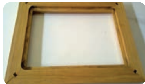
ب- قطعات فارسی بر شده شکل ۲-۳۱
