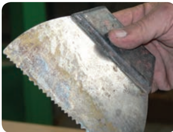
شکل ۹۲-۵- کاردک شانه‌ای
