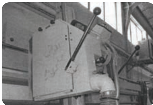
شکل ۳۹-۵- اهرم حرکت اره برای برش
