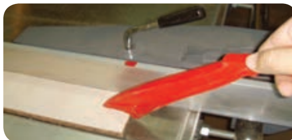
شکل ۵-۱۰۵- هدایت قطعه باریک به وسیله کمکی
