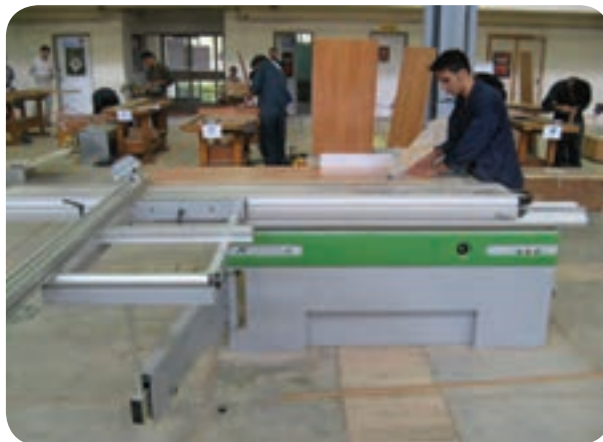
شکل ۵-۱۱۵- برشکاری قطعات سقف و کف
