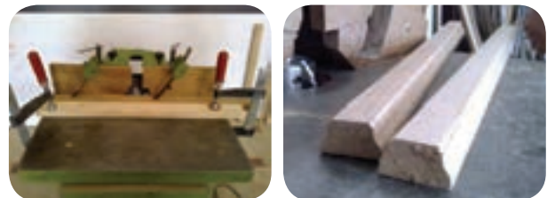
شکل ۲-۳۰- چوب ابزار خورده، ابزار زدن قطعه کار
