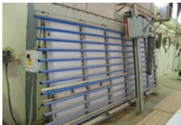
شکل ۳۳-۵- اره پانل بر عمودی
