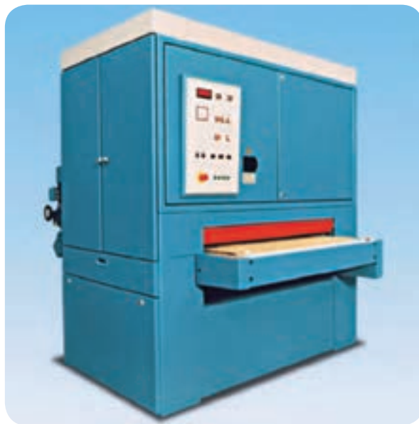
شکل ۷۳-۵ ماشین سنباده نوار غلتکی عمودی
