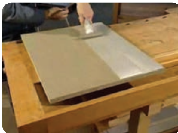
شکل ۹۳-۵- ابزار سربهن چسب‌زن پنوماتیکی
