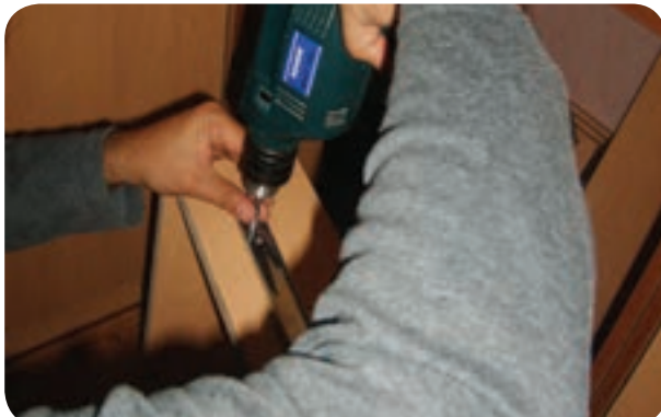
شکل ۱۷۶-۵ نصب ریل تکی به بدنه کشو
