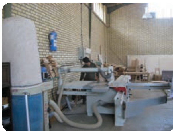
شکل ۵-۵۹- مکنده مناسب ماشین دورکن
