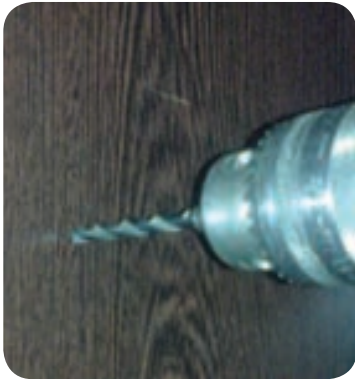
شکل ۱-۶- سوراخکاری دکور با مته چوب یا آهن
