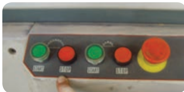
شکل ۵-۶۰- کلید خاموش و روشن کردن ماشین دورکن
