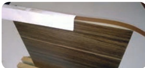
شکل ۴-۱۴ - نحوه استفاده از کاغذ در زیر اتو
