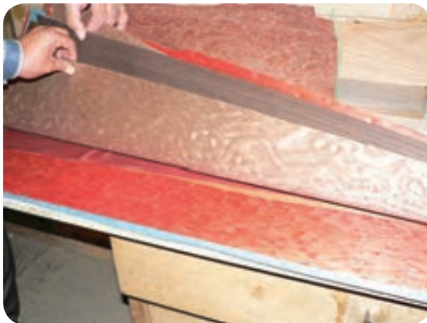
شکل ۷۱-۵- انتخاب روکش طبیعی مناسب
