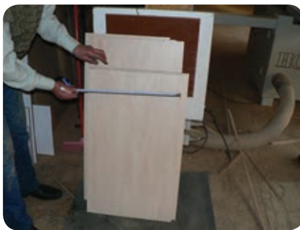
شکل ۵-۱۱۶- کنترل اندازه قطعات آماده شده
