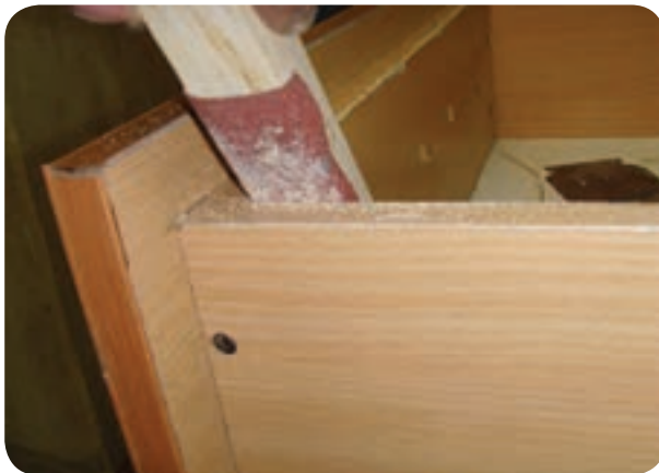
شکل ۵-۱۸۲- برطرف کردن لبهٔ تیز صفحات با سوهان
