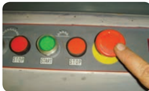
شکل ۵-۶۷- کلید خاموش کردن کلی ماشین دور کن
