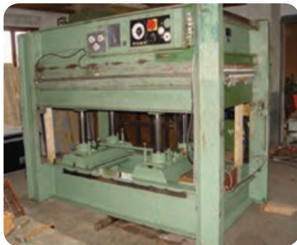
شکل ۷۴-۵ پرس گرم المنتی دو طبقه هیدرولیکی
