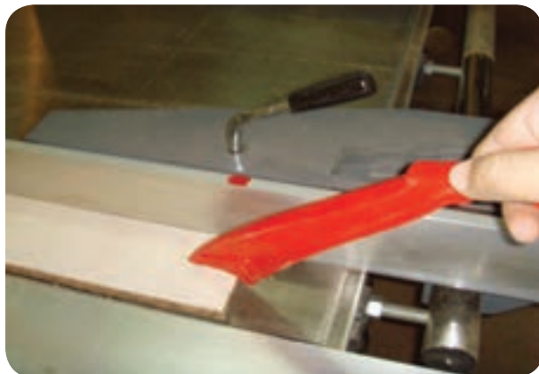
شکل ۵-۶۵- استفاده از وسیله کمکی هدایت قطعه باریک
