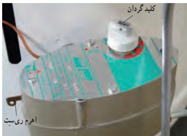
شکل ۱-۳۸- کاربرد اتور آب گرمکن نفت سوز
