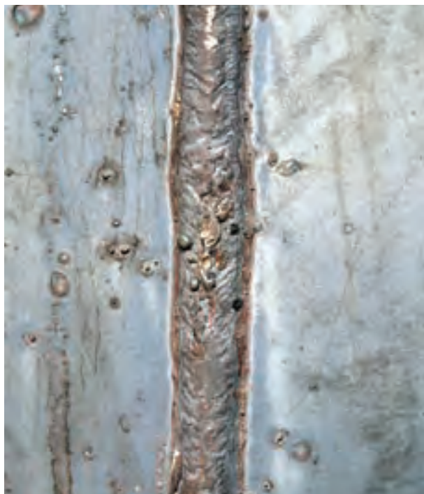
شکل ۱-۷- درز جوشکاری شده
