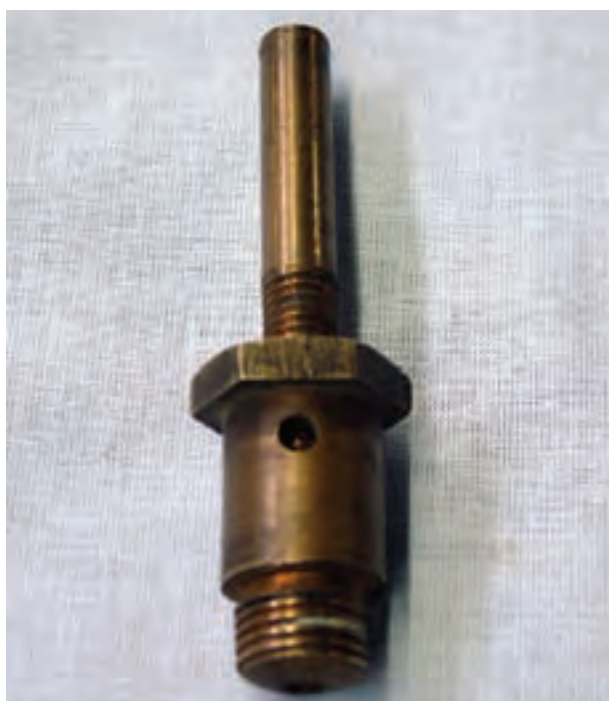
شکل ۱-۳۲- شیر قطع و وصل مخزن سوخت
