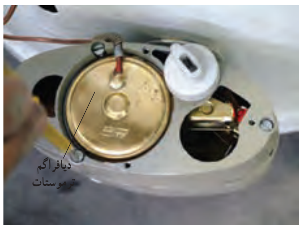
شکل ۵۵-۱- ب - دیافراگم ترموستات
