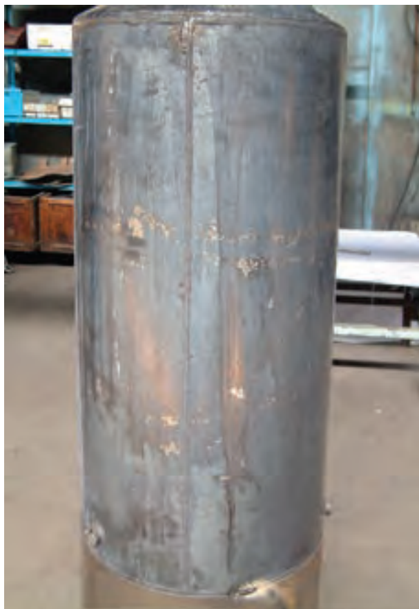
شکل ۱-۶- مخزن جوشکاری شده
