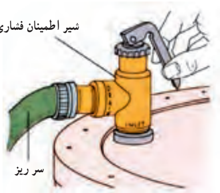
شکل ۲-۱۰۹- شیر اطمینان فشاری - حرارتی
