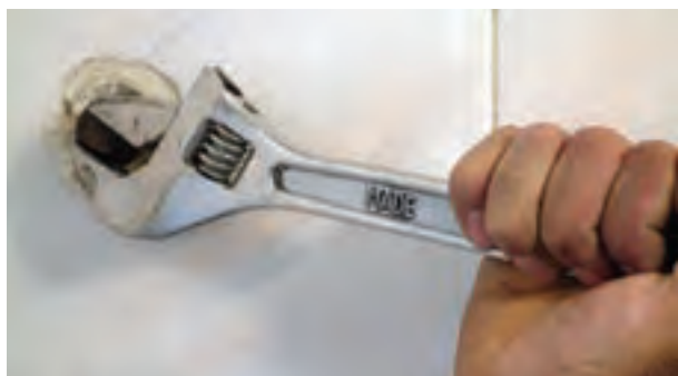
شکل ۱۹۸-۲- باز کردن درپوش‌ها
