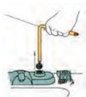
شکل ۲-۷۲- خارج کردن نشیمنگاه از شیر مخلوط. مراحل بازکردن نشیمنگاه از شیر مخلوط
