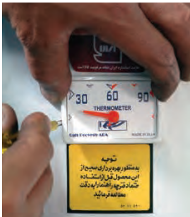
شکل ۱-۱۱۷ جدا کردن ترمومتر از روپوش
