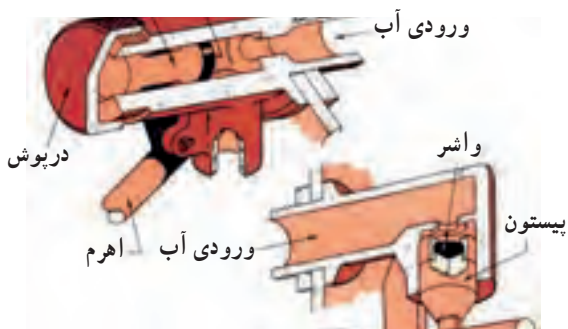
شکل ۱۱۳-۲ اجزای شیر شناور
