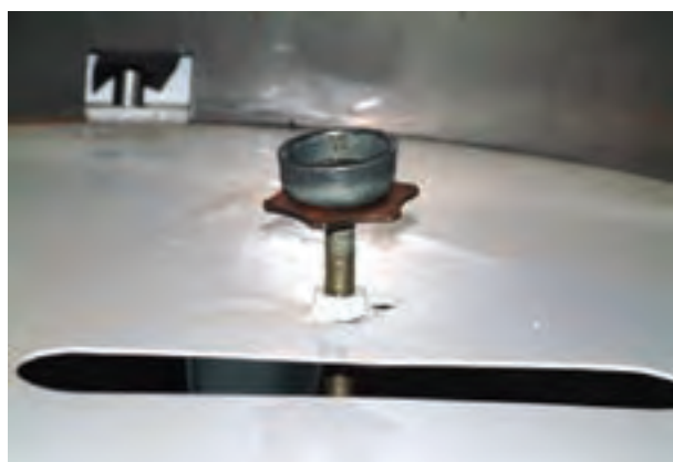
شکل ۹-۱- جک نصب شده بر روی شاسی
