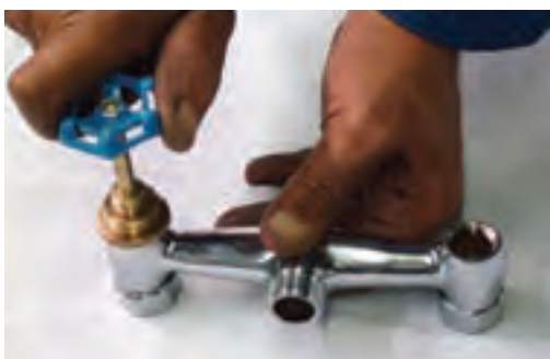
شکل ۲-۶۸- شیر تراش در حال کار شیر تراش
