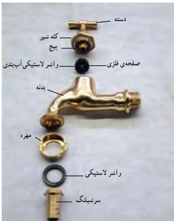
شکل ۱۲-۲-ب - اجزای شیر برنجی سرشیلنگی
