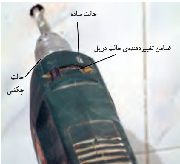
شکل ۲۱۲-۳ سوراخ کردن محل علامت‌گذاری شده
