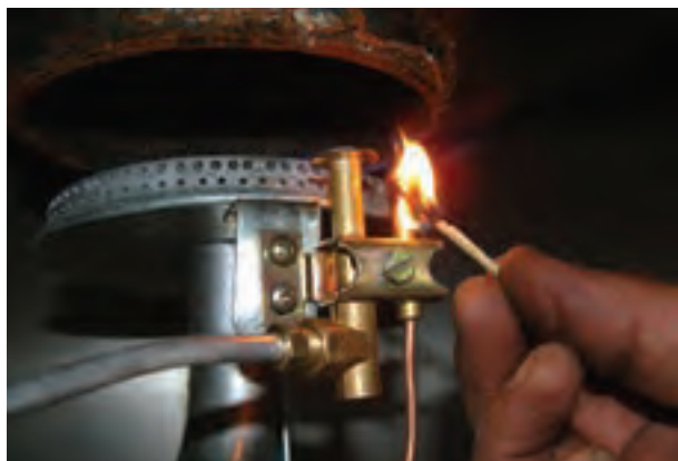
شکل ۱-۱۰۵ مشتعل کردن شمعی به وسیله‌ی شعله‌ی کبریت
