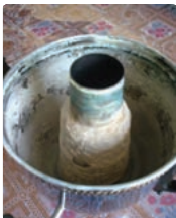
شکل ۸-۵- تشکیل رسوب در سماور و لوله‌ها
