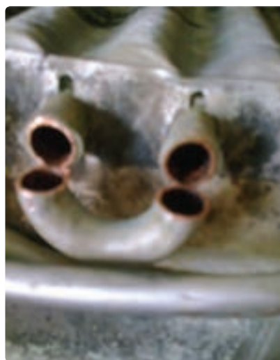
شکل ۱۳-۵- تشکیل رسوب در نقطه بالای شمعک
