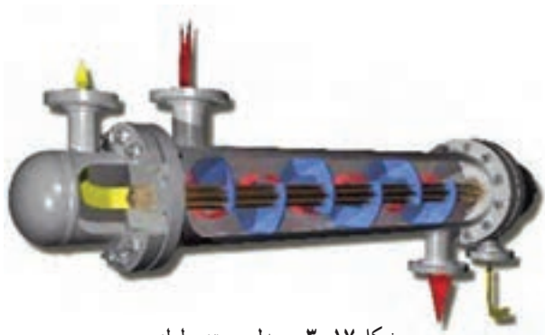
شکل ۳-۱۷- مبدل پوسته و لوله
