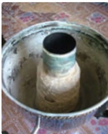
شکل ۸-۵- تشکیل رسوب در سماور و لوله‌ها
