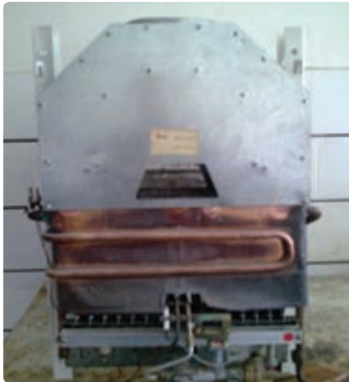
شکل ۱-۲- آب گرم کن گازسوز دیواری
