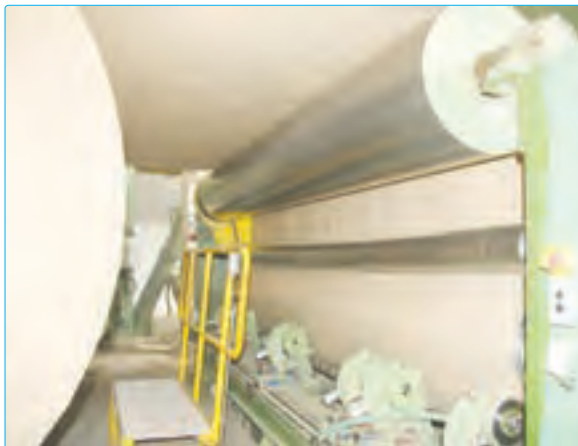
غلتک آهنی برای صاف کردن خمیر کاغذ
