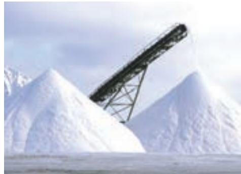
شکل ۱۳- استخراج و جداسازی سدیم کلرید به روش تبلور
