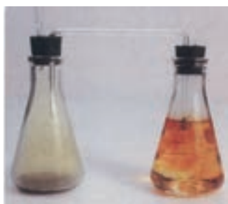
گاز کلر تولید شده در ارلن سمت چپ با محلول KBr در ارلن سمت راست واکنش می دهد.
