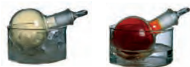
ب) تبدیل گاز بی‌رنگ N_2O_4 به گاز قهوه‌ای رنگ NO_2 شکل ۲- واکنش‌های برگشت‌پذیر
