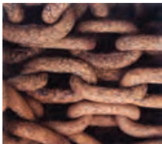
زنگ‌زدن یک زنجیر آهنی
