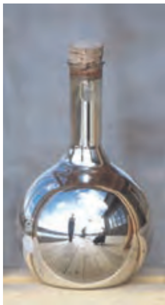
تشکیل آینه نقره‌ای هنگام اکسایش متانال
