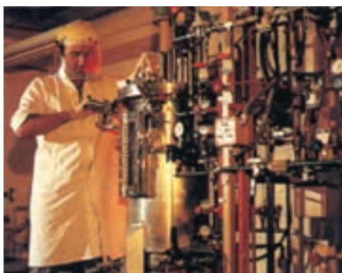
شکل ۱۱-۹- دستگاه تخمیرکننده (فرمانتور) صنعتی. باکتری‌ها برای تولید مواد شیمیایی مفید مورد استفاده قرار می‌گیرند.
