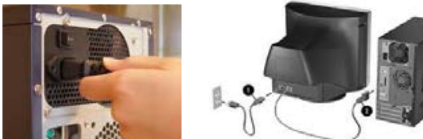
شکل ۱-۱ - کابل اتصال صفحه نمایش به کیس و کابل‌های برق صفحه نمایش و کیس
