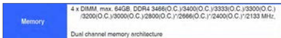
شکل ۹-۱۸- مشخصات ماژول حافظه در راهنمای برد اصلی
