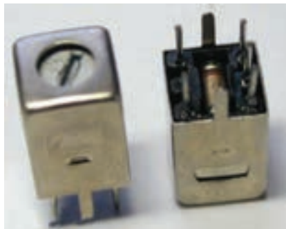
ترانس IF و خازن داخل آن
