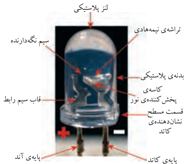
شکل ۱-۳ ساختمان داخلی LED
