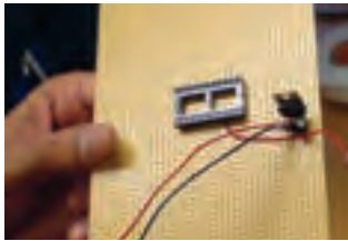
شکل ۱-۳۸- یک قطعه فیبر سوراخ‌دار که یک سوکت و ترانزیستور روی آن نصب شده است.
