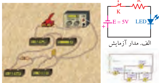
الف. مدار آزمایش ب. نقشه‌ی فنی مدار با ادیسون ج. مدار عملی با ادیسون
