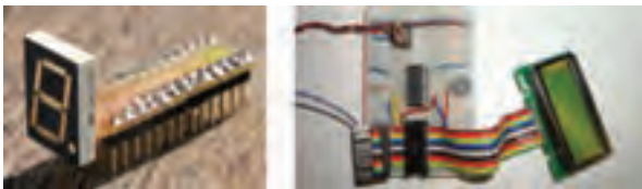
شکل ۳۴-۱- دو نمونه LED و نمایشگر LCD نصب شده روی سوکت
