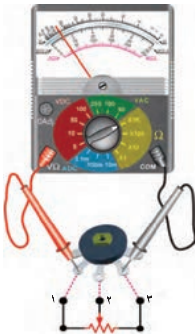
شکل ۱-۳۲- اندازه‌گیری مقدار کل مقاومت ولوم
