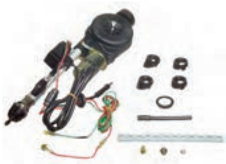
شکل ۲-۱۹- آنتن الکتریکی قابل نصب در گل‌گیر خودرو و متعلقات آن
