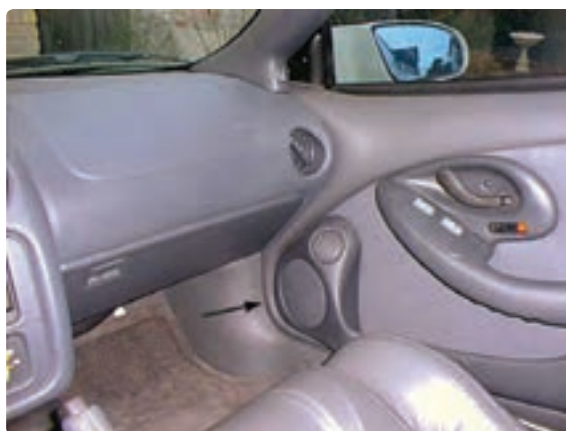
شکل ۲-۱۰- محل نصب بلندگو
