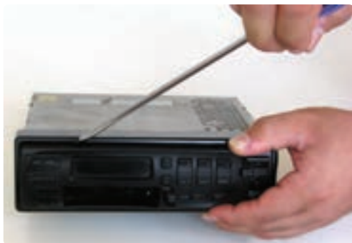
شکل ۲-۳۱- نحوه خارج کردن نادرست قاب
