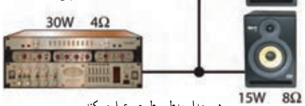
شکل ۵-۵ - اتصال بلندگو به خروجی تقویت کننده
