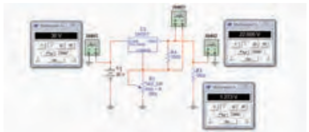
شکل ۱۳-۳-۱۳- یک نمونه مدار رگولاتور شبیه‌سازی شده با نرم‌افزار مولتی‌سیم
