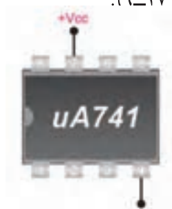
شکل ۹-۱۷- اتصال +V_{CC} و -V_{CC} به آی سی
