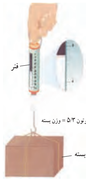
شکل ۲- با نیروسنج وزن یک جسم را اندازه گیری می کنیم.
