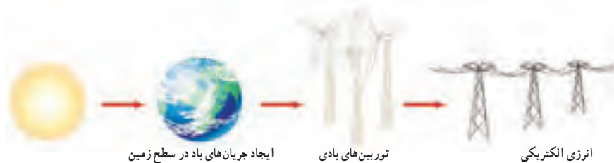
شکل ۶- تولید انرژی الکتریکی توسط توربین‌های بادی
