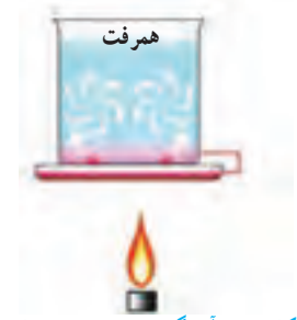
شکل ۸- آب گرم شده به سمت بالا حرکت می‌کند و آب سرد جای آن را می‌گیرد.
