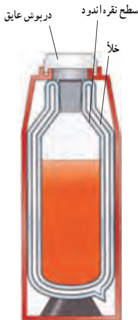
شکل ۱۳- فلاسک خلأ می‌تواند مدت نسبتاً زیادی دمای جسم را تقریباً ثابت نگه دارد.
