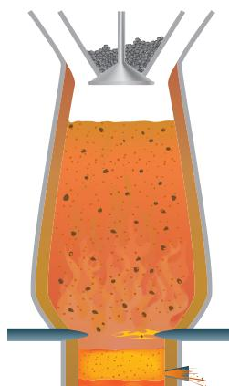
پ) گرما دادن مخلوط سنگ آهن, کربن و سنگ آهک
