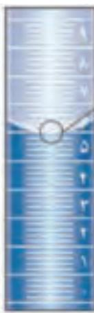
شکل ۴— از استوانه مدرج برای اندازه‌گیری حجم مایع استفاده می‌شود. این ظرف بر حسب سانتی‌متر مکعب مدرج شده است.
