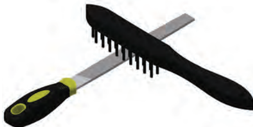
شکل ۱۷-۱- تمیز کردن سوهان با برس سیمی
