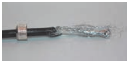
۲- کابل را به اندازه حدود ۲ سانتی متر روکش برداری کنید و پیچ بدنه خارجی را مشابه شکل از داخل آن رد کنید.
