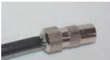
۸- بدنه خارجی را به پیچ مربوطه ببندید و صحت اتصالات با یک اهم متر بررسی کنید . مفتول کابل مسی به سیم افشان نباید اتصال داشته باشد .
