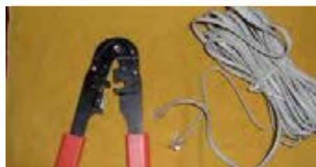
۷- سیم تلفن با دو سر فیش مخصوص اتصال آماده است.
