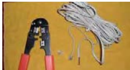
۵- سر دیگر کابل را هم روکش برداری کنید و مانند حالت قبل با توجه به رنگ بندی کنار هم قرار دهید
