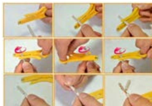
شکل ۷- روکش برداری کابل
