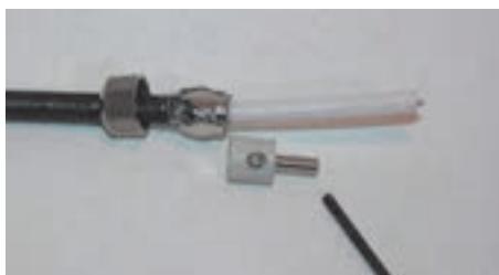
۵- سوزنی اتصال را برداشته و پیچ آن را چند دور باز کنید .
